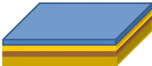
Рисунок 2: Результат технологической операции «Нанесение фоторезиста»
