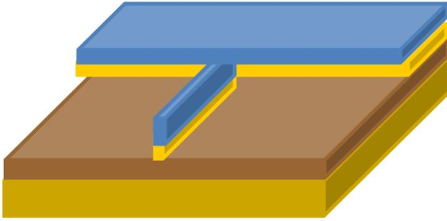
Рисунок 5: Результат технологической операции «Реактивное ионное травление» кремния»
