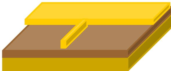
Рисунок 6: Результат технологической операции «Удаление остатков фоторезиста» микроструктурами МЭМС-изделия помещается в ванну с бурлящим раствором смеси КАРО.
