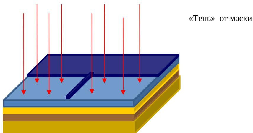
Рисунок 3: Технологическая операция «Экспонирование фоторезиста»
