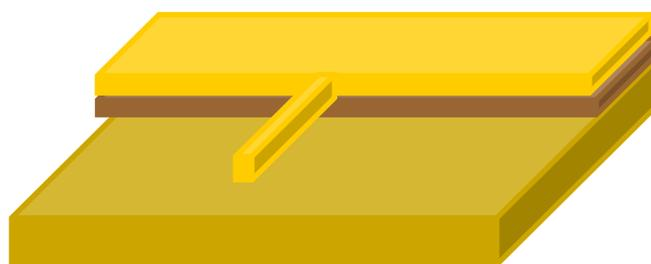
*Рисунок 1: Упрощённая модель конструкции МЭМС-устройства «Кантилевер»*
