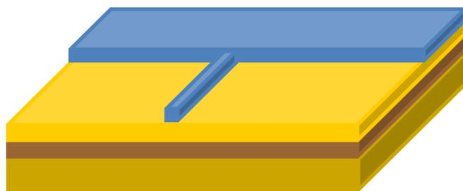
Рисунок 4: Результат технологической операции «Проявление фоторезиста»
