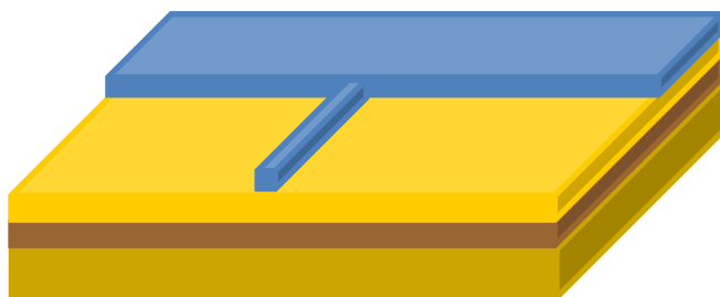
Рис.4. Результат технологической операции «Проявление фоторезиста»
