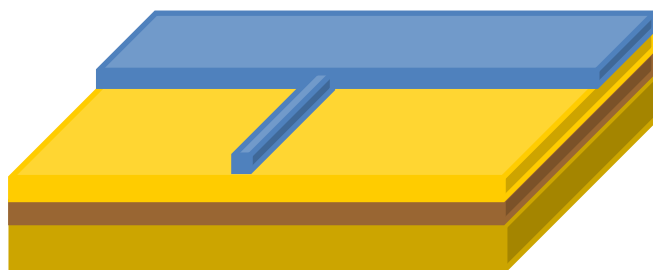
Рис.4. Результат технологической операции «Проявление фоторезиста»
